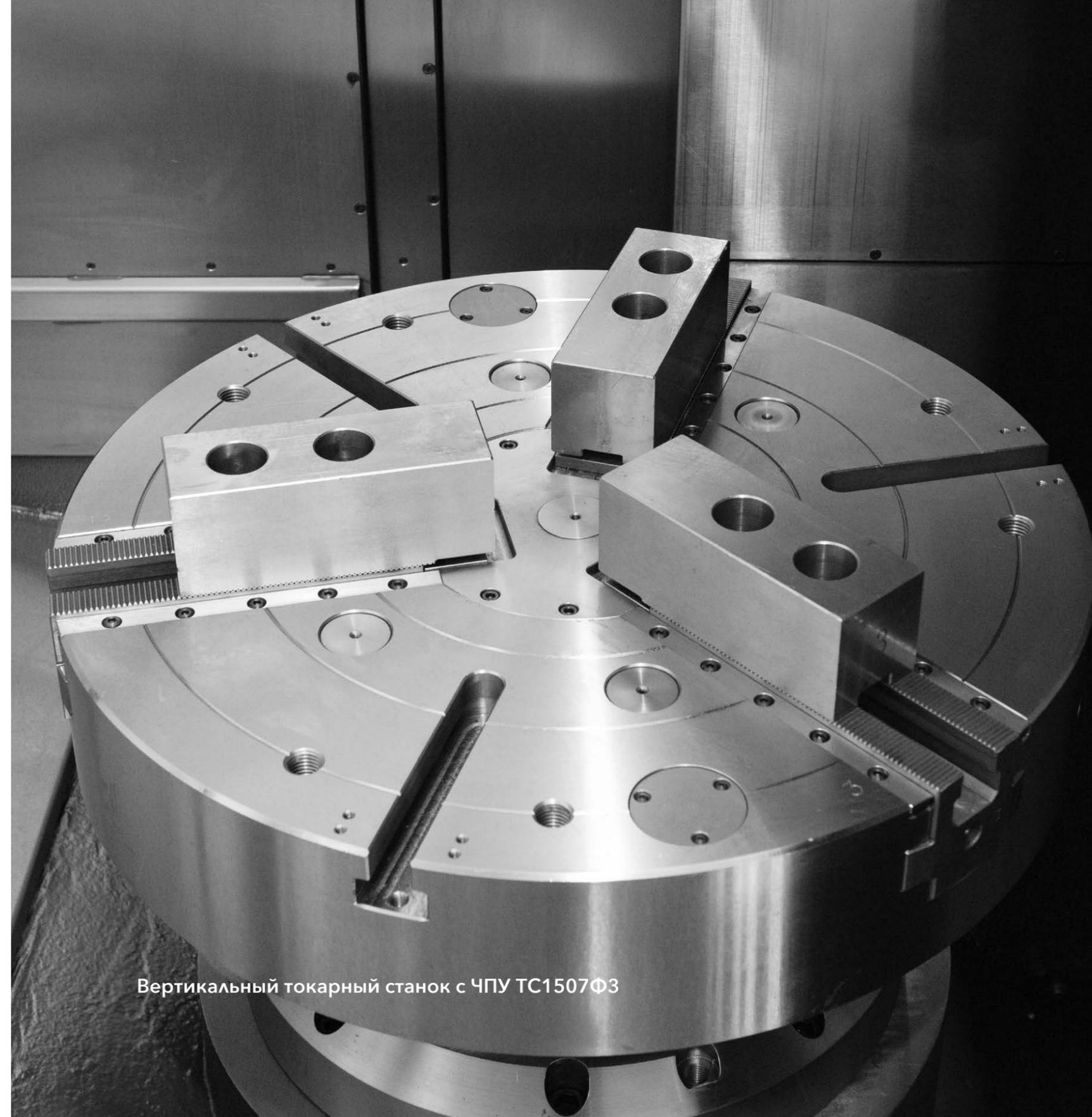
Вертикальный токарный станок с ЧПУ ТС1507Ф3
