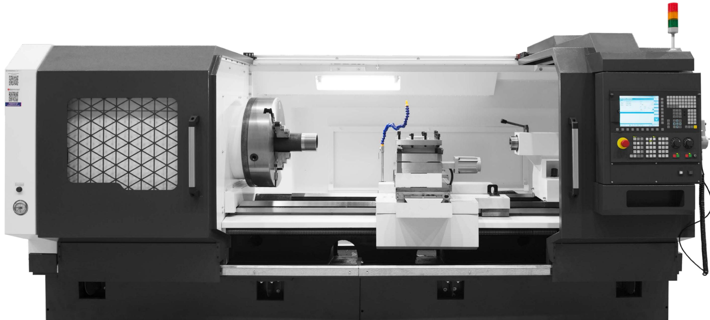
Трубоарезной станок с ЧПУ TC16T27Ф3
